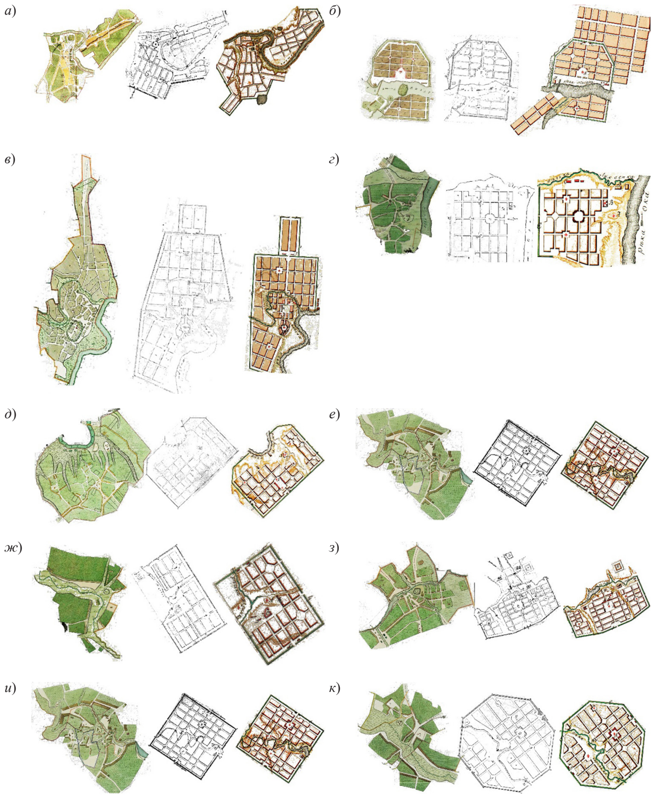
Начало. Дорегулярные планы, «высочайше подтвержденные» планы и варианты регулярных планов уездных городов Калужской губернии: а – Боровска; б – Жиздры; в – Козельска; г – Лихвина; д – Малоярославца; е – Медыни; ж – Мосальска; з – Мещовска; и – Перемышля; к – Серпейска
